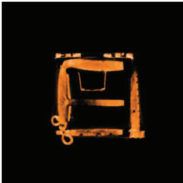
Obr. 2. Rentgenový snímek visacího svorníkového pružinového zámku, na němž je patrná délka břevna.
